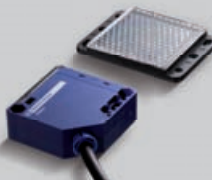
Reflexivní světelná závora Extra 628 • 24-240 V AC, 12-240 V DC, IP 54 • dosah 5 m • lze použít pouze jako vysílač impulsů
